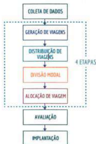
Figura 23 - Fluxograma de estudo para planejamento de transportes
