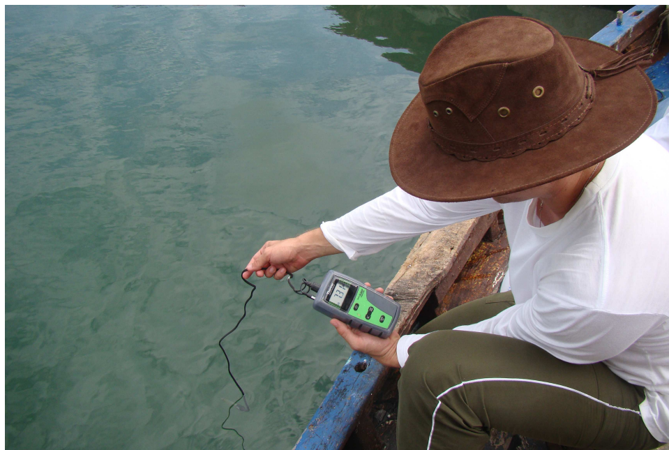
Figura 07. Medição de pH e Temperatura in loco.
