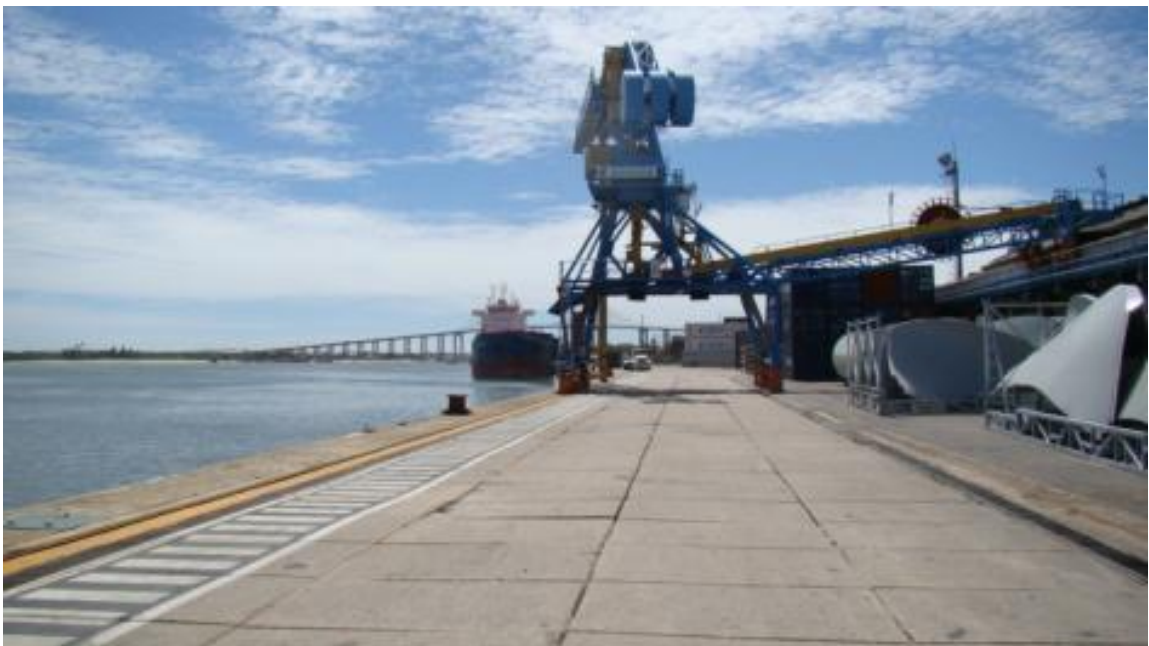
Figura 55 - Equipamento do tipo Portalino - descarregamento do trigo a granel
