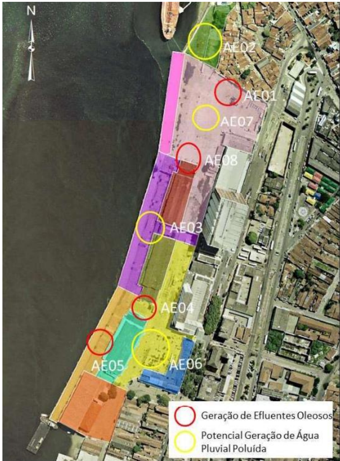
Figura 35 - Área de Geração de efluentes oleosos com potencial geração de água pluvial contaminada
