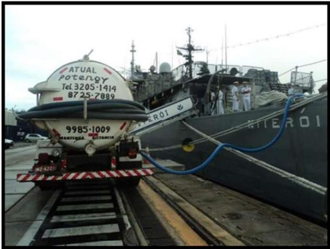
Figura 34 - Registro de retirada de efluentes sanitários de embarcação
