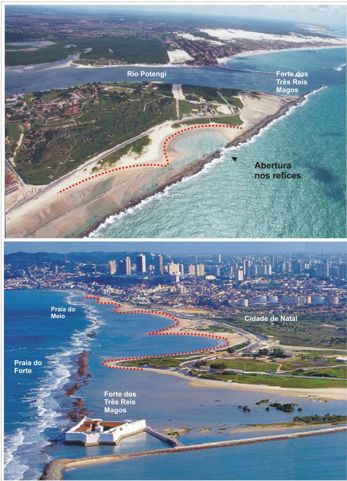
Figura 7 – Formato em cúspides das praias do Forte e praia do Meio, ocasionado pelo efeito da difração das ondas incidentes que ultrapassam a linha de refices de arenito.
