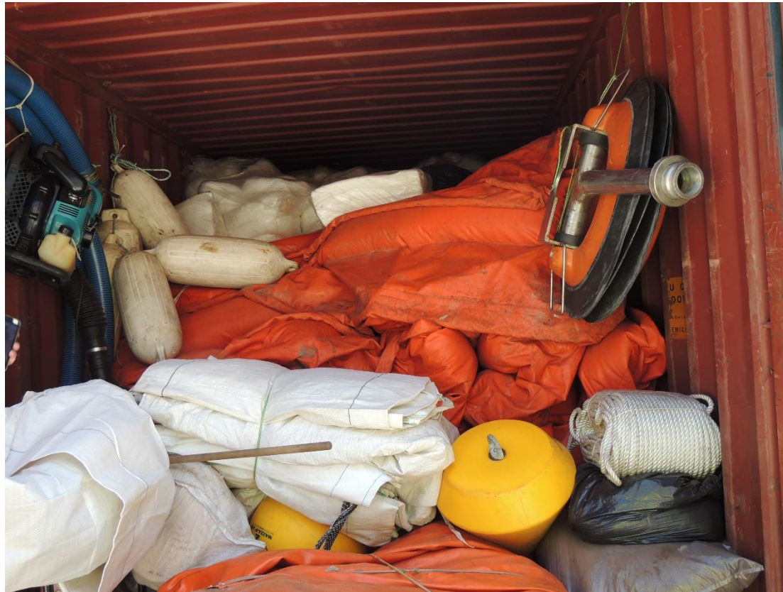
Foto 54 – Material de para contenção e recolhimento de óleo em mar localizado no Terminal.
