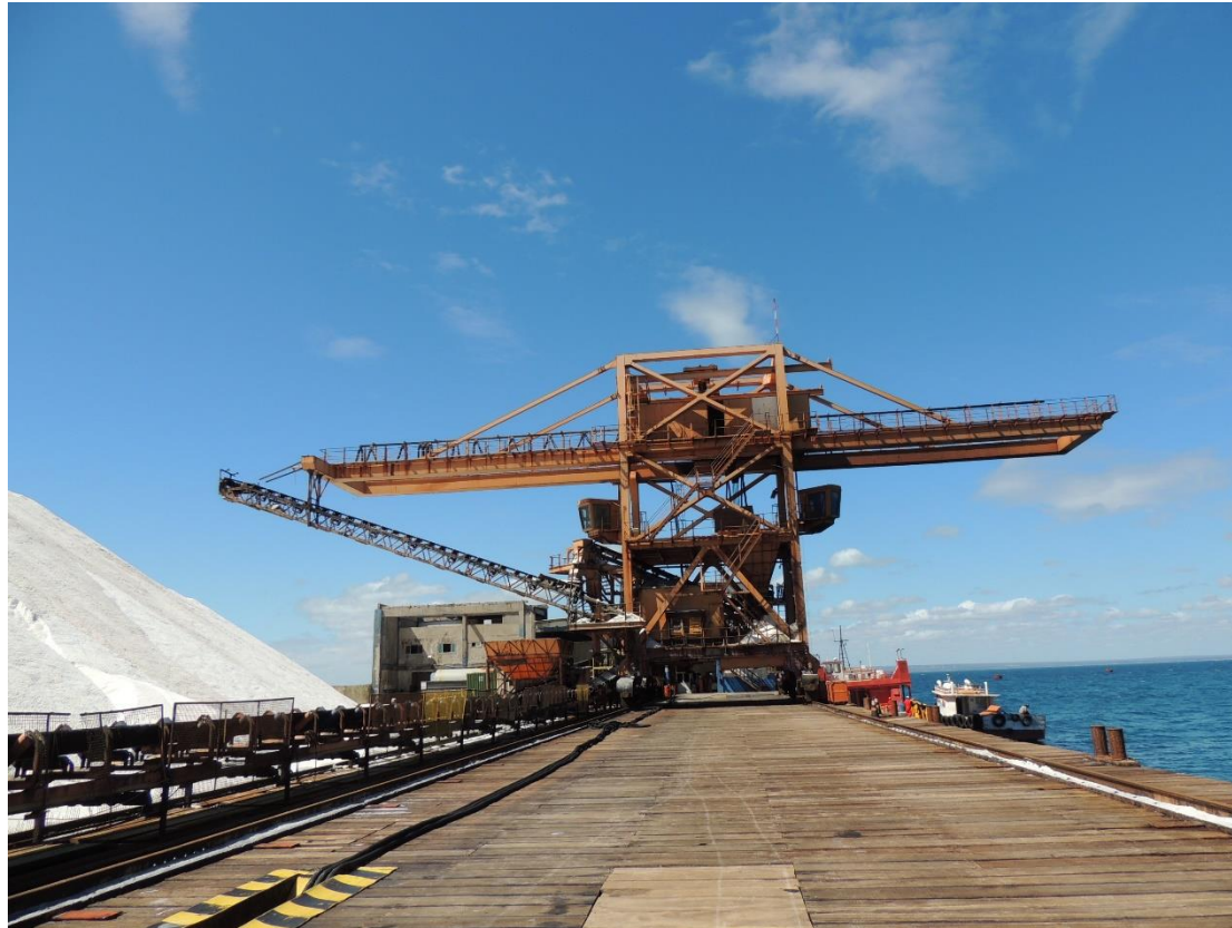
Foto 28: Esteira para movimentação do sal no terminal.
