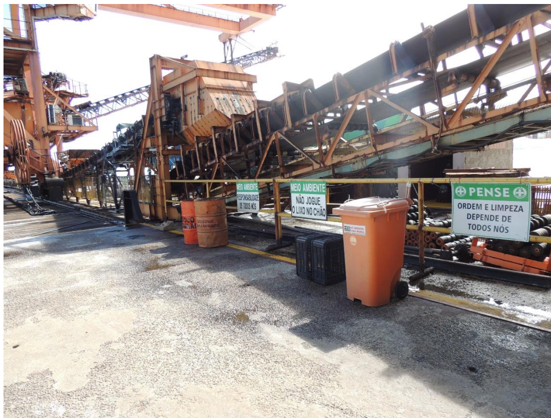
Foto 52 – Kit com material de contenção e recolhimento de óleo “em terra” localizados no terminal.
