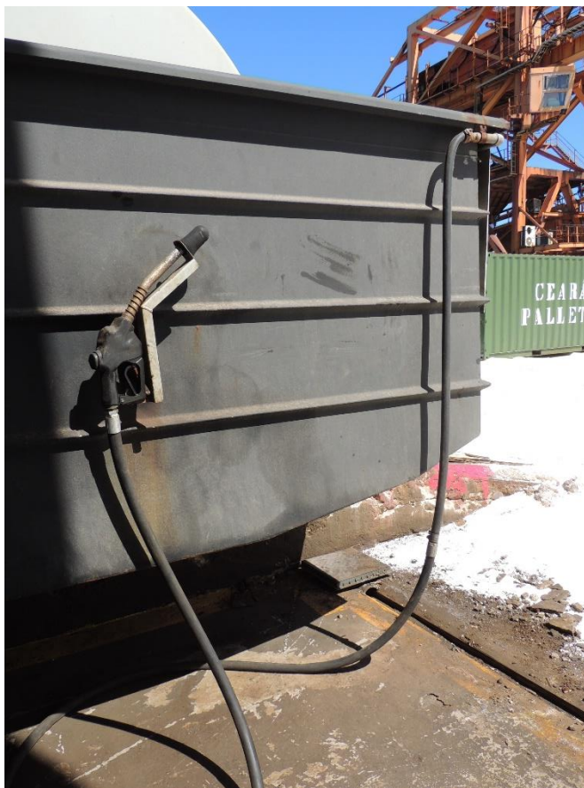
Foto 32 – Bomba para abastecimento das máquinas (pá carregadora, trator)
