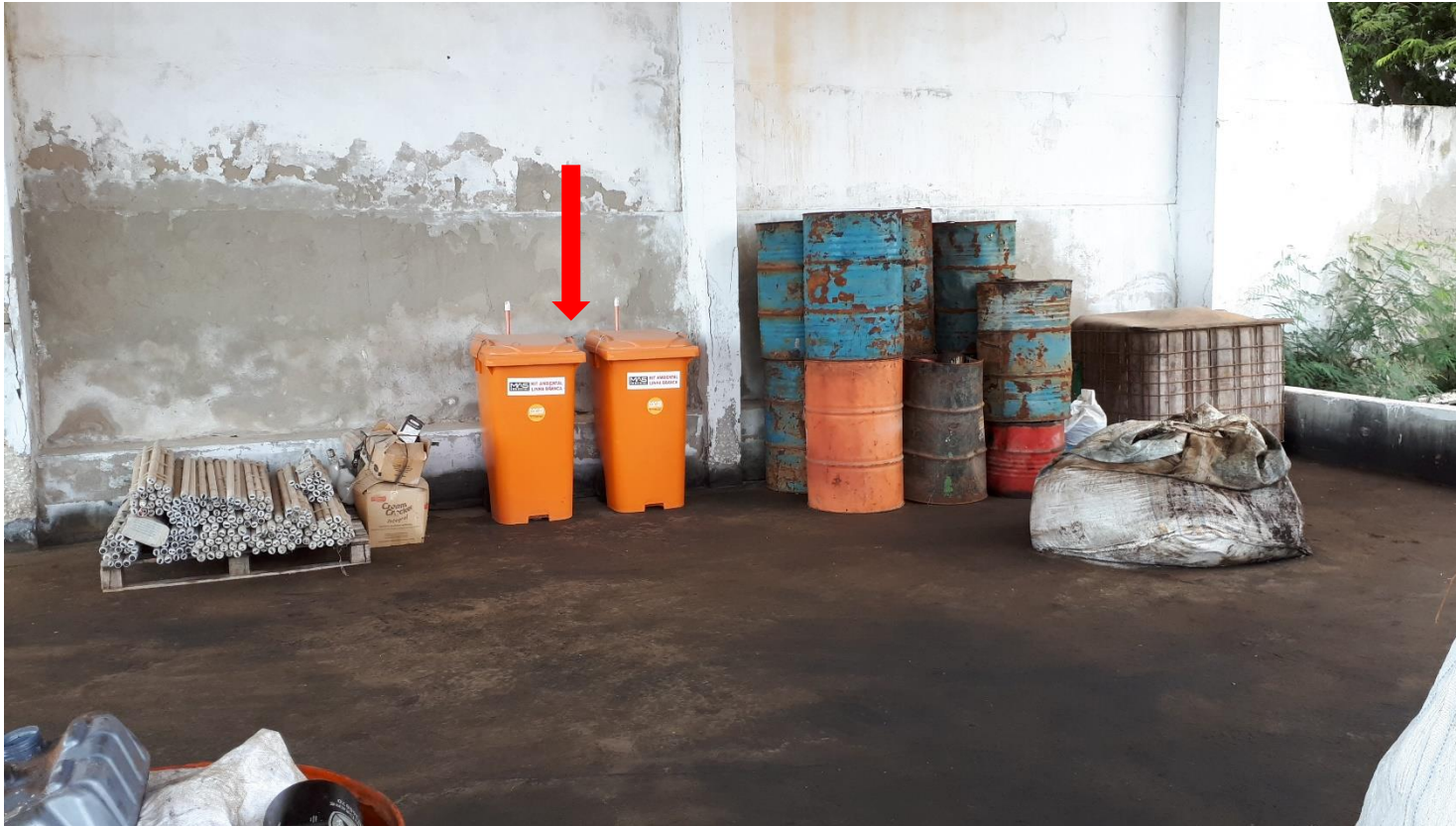
Foto 49 – Local de disposição de resíduos. Kits com material de contenção e recolhimento de óleo “em terra”.
