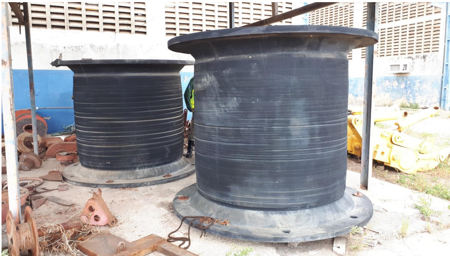
Foto 17 – Material das defensas do cais dos navios em terra na CODERN em Areia Branca
