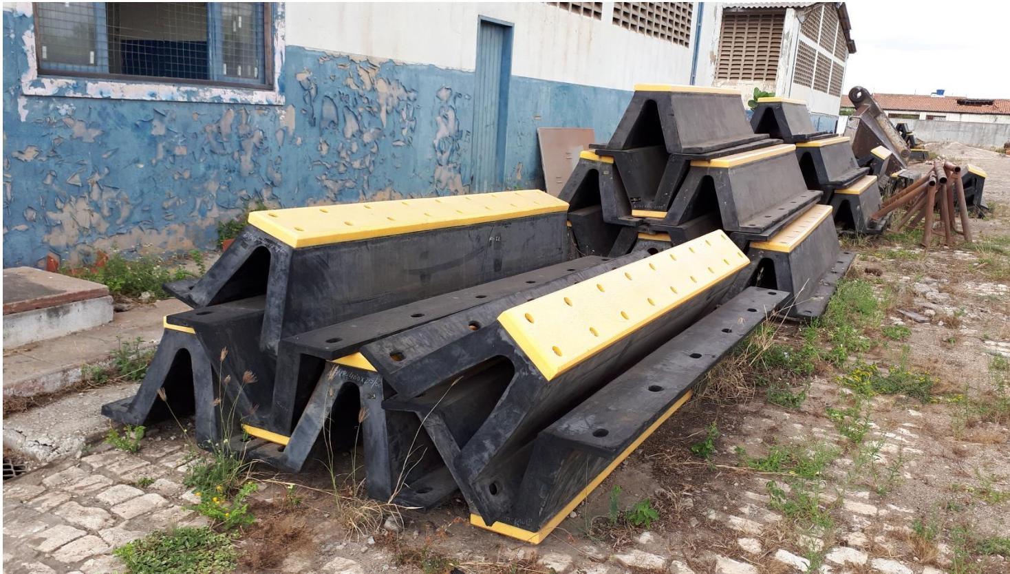
Foto 19 – Material das defensas do cais das barcas em terra na CODERN em Areia Branca
