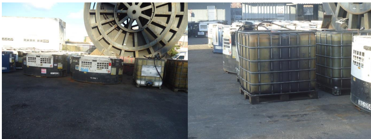
FIGURA 28: Geradores portáteis de contêineres.
