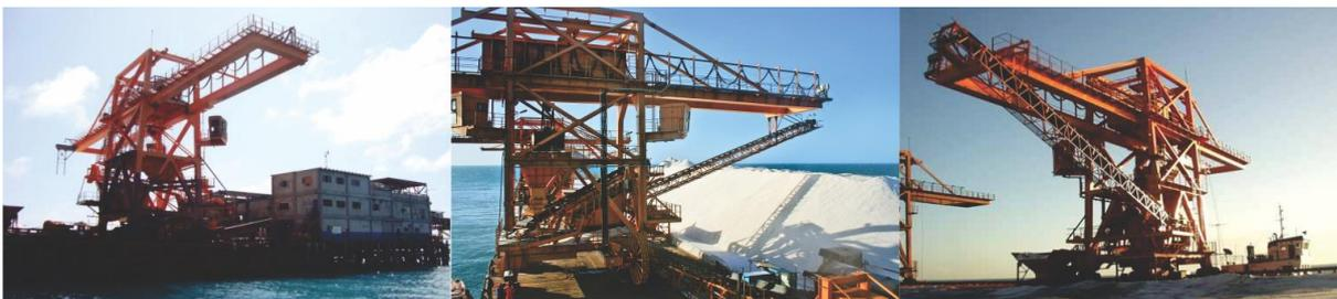
**Figura 28.** Descarregadores de Barcaças do Terminal Salineiro de Areia Branca
